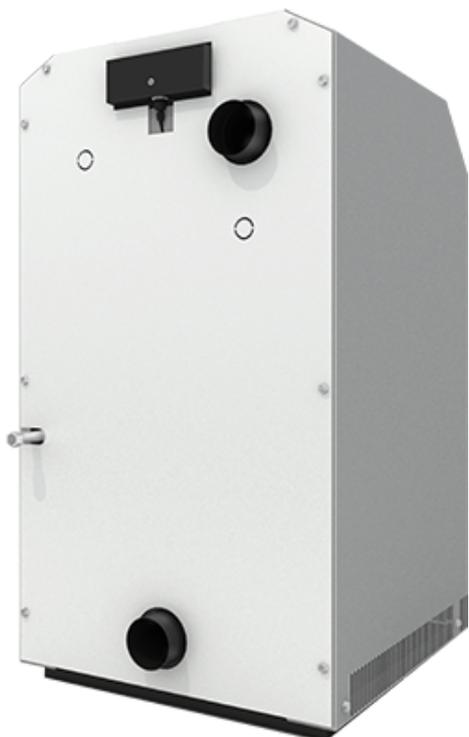
Котлы «Лемакс» серии «Премиум» NOVA изготовлены из высококачественной стали 2 мм повышенной плоскостности Магнитогорского металлургического комбината. Благодаря покрытию антикоррозийной эмалью «CERTA» (температура воздействия 750°C) и обработке ингибирующим составом, теплообменник защищен от агрессивных факторов: растворов солей, минеральных масел.
