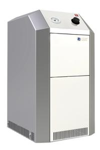
Котлы «Лемакс» серии «Премиум» изготовлены из высококачественной стали 2 мм повышенной плоскостности Магнитогорского металлургического комбината. Теплообменник имеет цилиндрическую форму, что позволяет работать котлу в закрытых системах с рабочим давление 2 атм. Благодаря покрытию антикоррозийной эмалью «СЕRTA» (температура воздействия 750°С) и обработке ингибирующим составом, теплообменник защищен от агрессивных факторов: растворов солей, минеральных масел.
